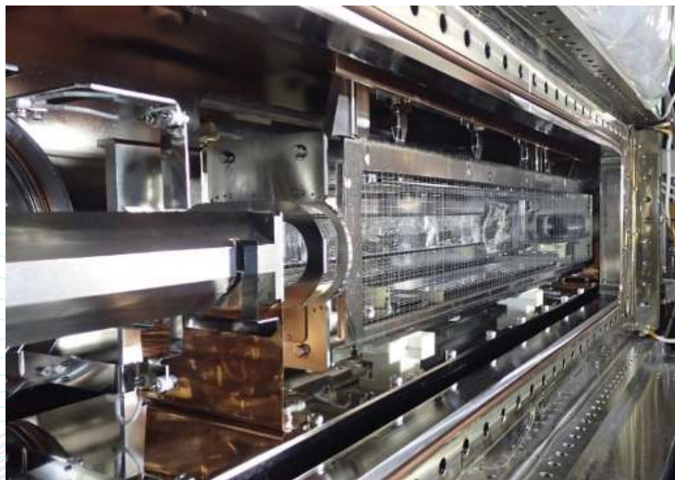
圖1。即使是半衰期太短而無法製成固體靶的放射性離子，仍然可以被困在電子束中。電子束本身固定離子兩個維度的運動；用細金屬線打造的籠子創造出一個電位，將它們在第三維度中固定。
