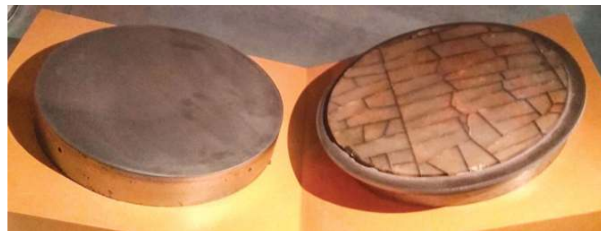
圖3.先前屬於法國海軍的諧振石英夾心式換能器。這個直徑為10公分的儀器目前正在巴黎ESPCI展出。它已經被打開來展示著在右側四分之一波(quarter-wave)鋼板上的石英馬賽克。
