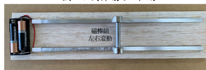
圖 2: 磁棒組加速滾動
